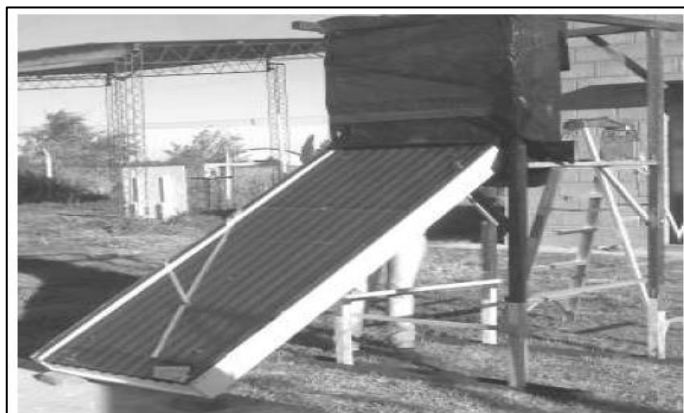
Figura 19.- Secador solar indirecto.
