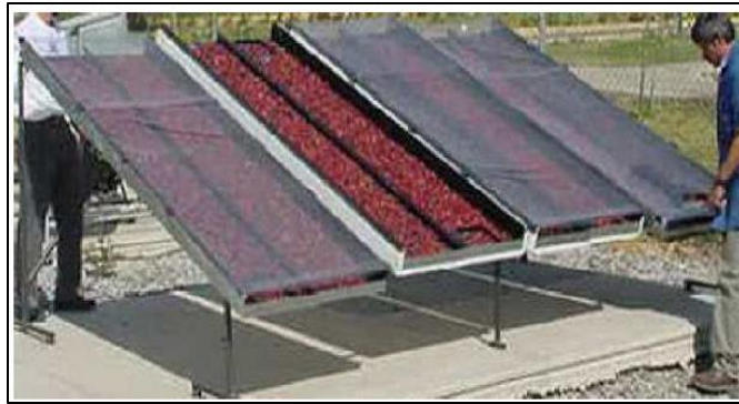
Figura 18.- Secador solar directo.
